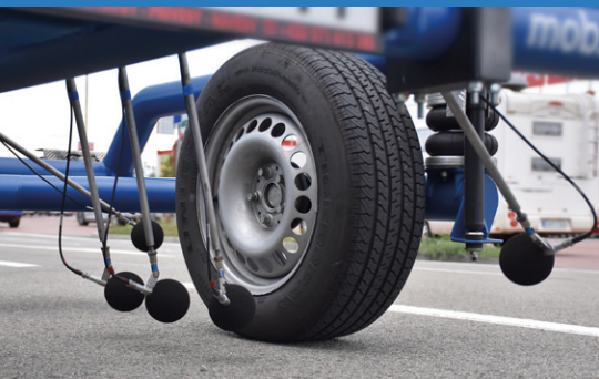
Detail na rozmístění měřících mikrofonů okolo standardní referenční pneumatiky (SRTT)
