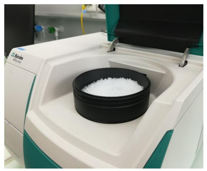
Figure 1. DS2500 Solid Analyzer with PP pellets filled in the rotating DS2500 Large Sample Cup.
