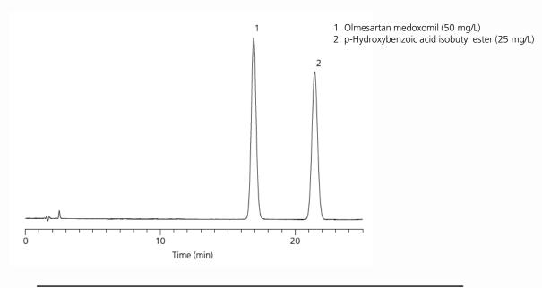
Column : Shim-pack GIST C18 (150 mmL. x 4.6 mml.D., 5 μm), P/N : 227-30017-07
