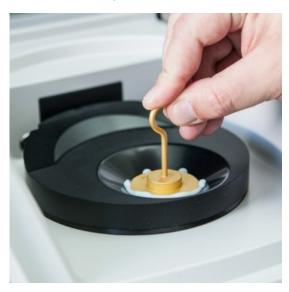
Fig. 2: Used accessories: DS2500 Slurry Cup and 1mm Gold Diffuse Reflector.
