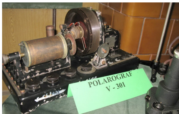
Obr. 1. Prvý sériovo vyrábaný polarograf V-301 z roku 1949
