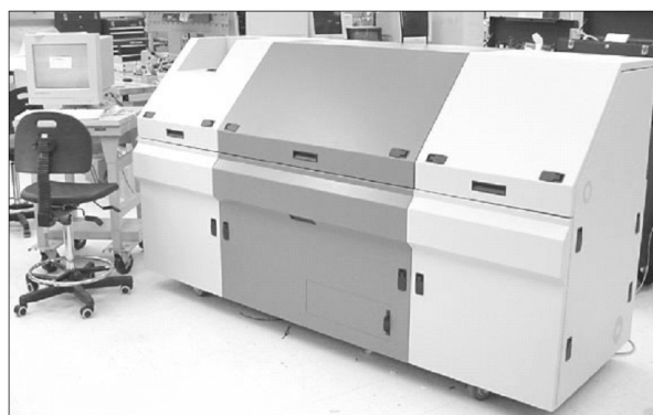
Obr. 2. Přístroj 4700 Proteomics Analyzer MALDI-TOF/TOF™; patentovaná TOF/TOF optika umožňuje získávat data v lineárním a reflektorovém módu a následující analýzu sekvence v MS/MS módu
